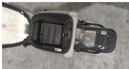
第三步：电源弯头线插入电池插头，合上空气开关
