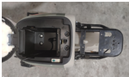
第一步：打开座垫并将充电器输入插头与主电缆连接
