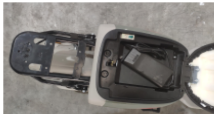
第四步：将充电器隔板与充电器装配到位
