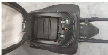
第三步：电源弯头线插入电池插头，合上空气开关
