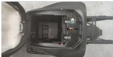
第一步：打开座垫并将充电器输入插头与主电缆连接
