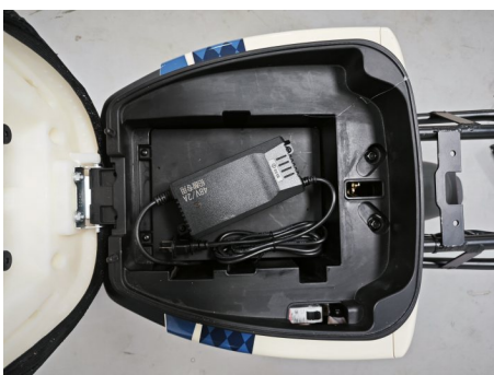
第五步：将充电器隔板与充电器装配到位
