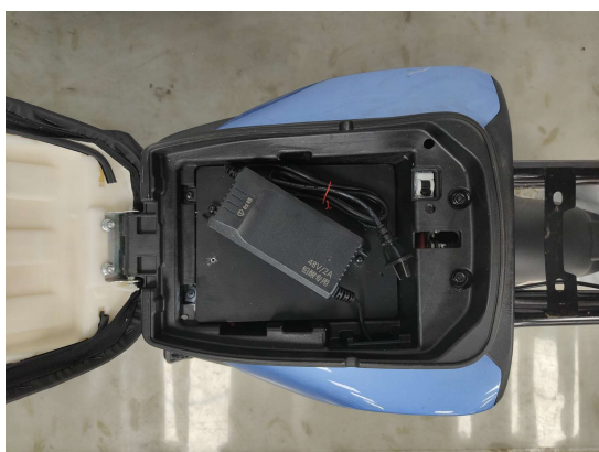
第五步：将电池连接线固定安装
