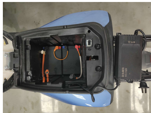
第二步：放入第一、二块电池 并连接电池正极于电缆线、并将 一根电池连接线负极固定到蓄电池上
