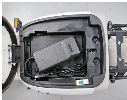
第四步：将充电器输出插头 与主电缆连接，将充电器隔 板与座桶装配到位
