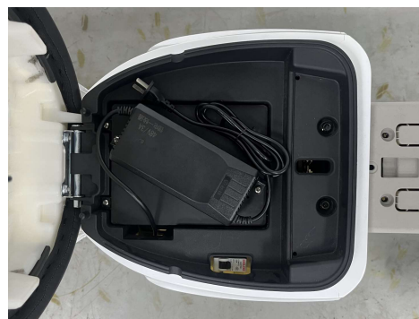
第四步：将充电器隔板与充电器装配到位
