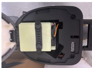
步骤3: 将电池放入座桶内，主线 电源线插头插入电池放电插口处
