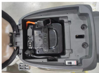
步骤2: 将电池盒沿电池盒滑轨安装.
