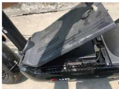
步骤1: 用钥匙打开脚踏板 的电池 盒盖
