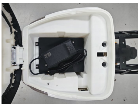
第五步：将控制器隔板与充电 装配到位
