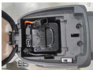
步骤2: 将电池盒沿电池盒滑轨安装.
