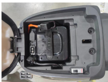
步骤3: 调整主线束插口方向， 正确将主线电源线插头插入电 池放电插口处
