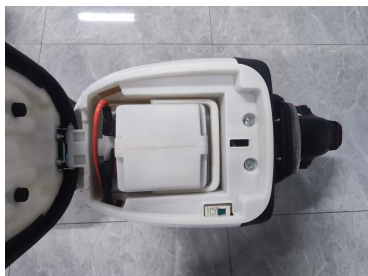
步骤7: 将放电插头、充电 插头接入电池盒
