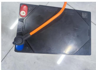
步骤3: 将电池端子绝缘保护套盖好
