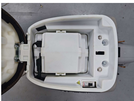
第七步：电源弯头线插入电池插头，合上空气开关
