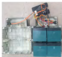
步骤2：装入电池、正确 连接电源线
