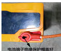
步骤3：将电池端子绝缘保护套盖好
