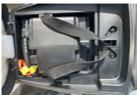
步骤7：将放电插头、充电插头 接入电池盒
