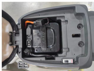
步骤2：将电池沿电池盒装入，将主线电源线插头插入电池放电插口处
