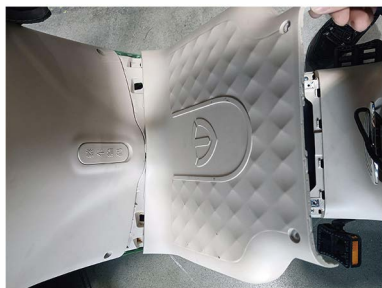
步骤1：打开脚踏板电池的 电池盒盖
