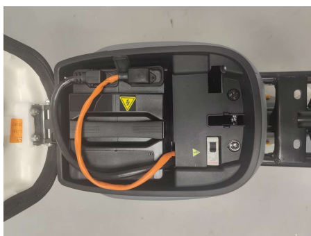
第三步：电源弯头线插入电池插头，合上空气开关
