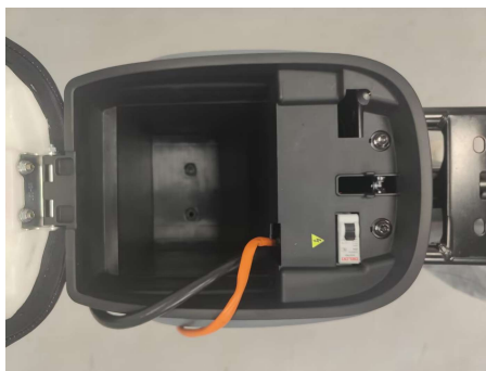
第一步：打开座垫并将充电器输出插头与主电缆连接
